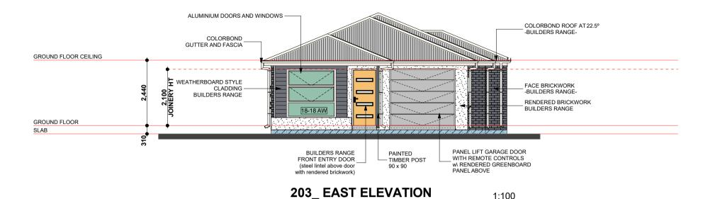
COLORBOND ROOF AT 22.5° -BUILDERS RANGE-COLORBOND GUTTER AND FASCIA ALUMINIUM DOORS AND WINDOWS GROUND FLOOR CEILING 2,100 JOINERY H GROUND FLOOR SLAB SELECTED FACE BRICK\_\_\_\_\_\_
